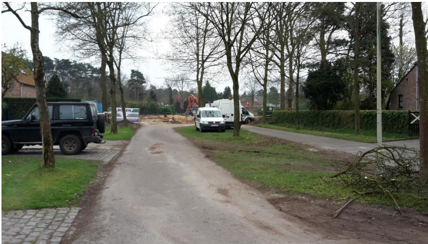
Lokale woonstraat (lokale weg type III) Bebouwde kom Weginrichting in asfalt (geen voetpaden – geen fietspaden) - +/- 5m
